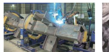
柱大組立溶接口ボットシステム
