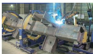
柱大組立溶接口ボットシステム
