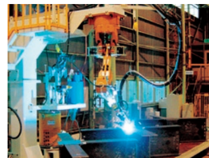
溶接ロボット
